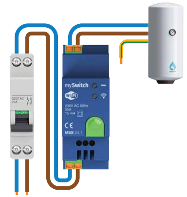
Διάγραμμα συνδεσης με Θερμοσίφωνα (B)
